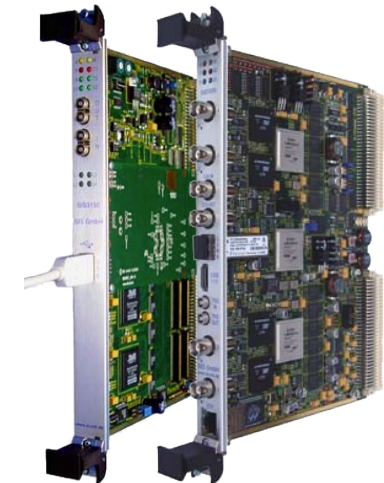
Struck 500MS/s 12bit 500MHz VME SADC
