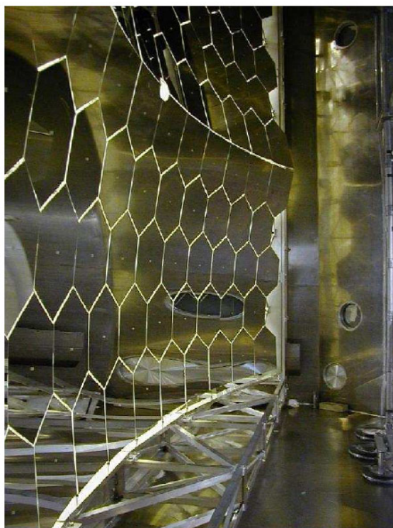
Figura 2.8: Il muro di specchi del RICH visto dall'interno del guscio. Nella foto sono visibili tutte e due gli specchi, quello superiore e quello inferiore
